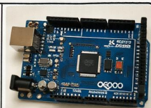
Arduino Mega 2560 ATmega2560 • 54 I/O 16MHz • 5V
